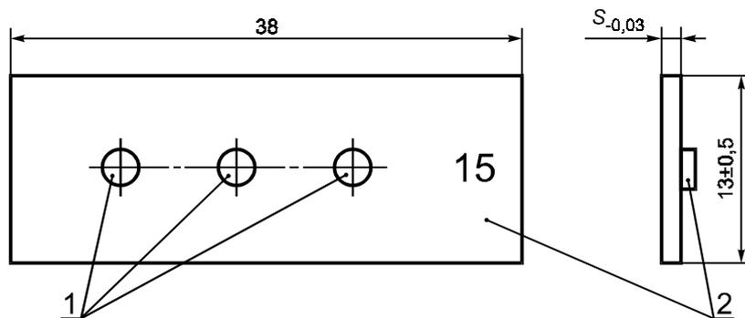
1 — отверстие  $\varnothing 1,6$  мм; 2 — шифр пенетрометра
