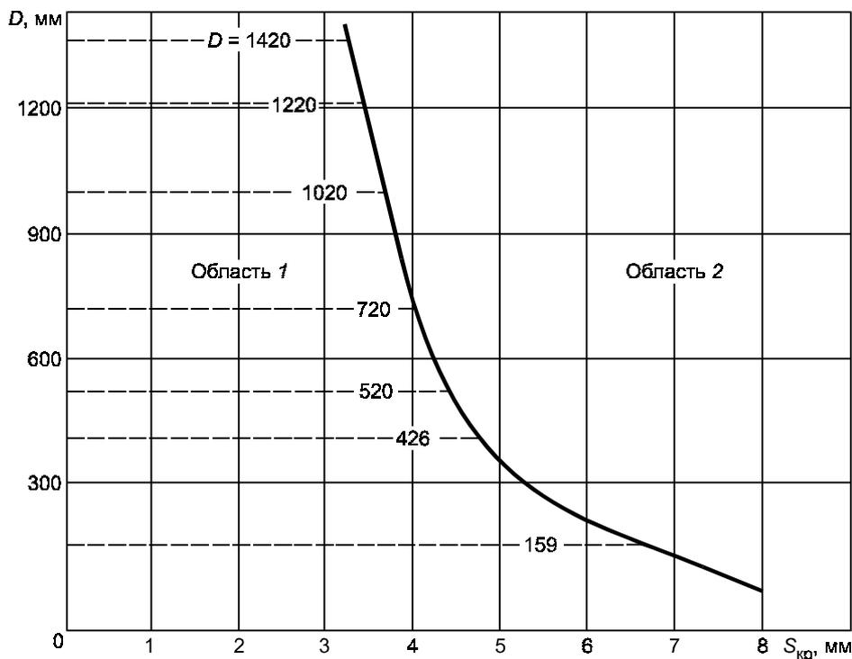
$D$  — диаметр трубы;  $S_{кр}$  — критическая толщина стенки, при которой оба дефекта («длинный» и «короткий») в равной степени влияют на предельную прочность сварных труб
